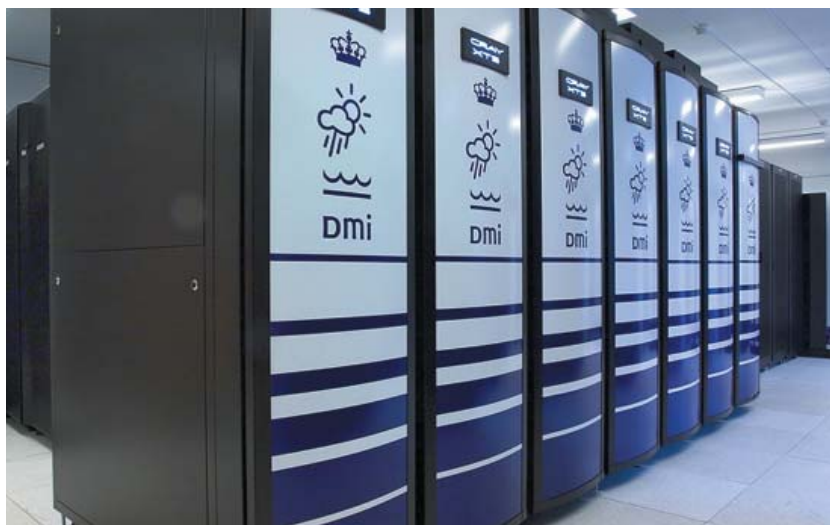
DMI's supercomputer (Cray-XT5) består af 4096 kerner og har 8 TB hukommelse. Det samlede filsystem udgør 110 TB. Supercomputeren, der kører fremtidens klimamodeller, har dermed en computerkraft, der svarer til 3.500 almindelige, moderne computere.
